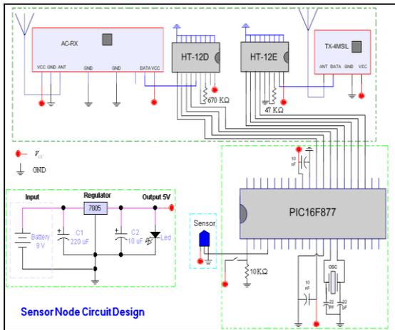
Fig. 6.a Sensor Node Circuit
