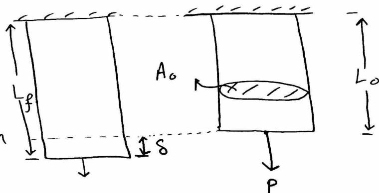
$$\text{stress} (\sigma) = \frac{P}{A_0} \quad [\text{Pa}]$$
