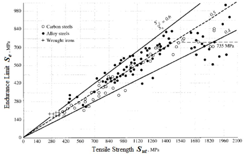
$$S_e' = \begin{cases} 0.5 S_{ut} & \text{for } S_{ut} \leq 1400 \text{ MPa} \\ 700 \text{ MPa} & \text{for } S_{ut} > 1400 \text{ MPa} \end{cases}$$
